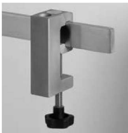
EV19799-03 Leichtmetall-Klemm- sockel Spannbreite 35 mm, für ein Schraubstativ mit Ø 16 mm/M10, für Schienen 25/35 x 8/10 und Rohre Ø 12 - 35 mm. Clamp socket made of light metal, holding width 35 mm, for screw stand Ø 16 mm/M10, for rails 25/35 x 8/10 and tubes Ø 12 - 35 mm.
