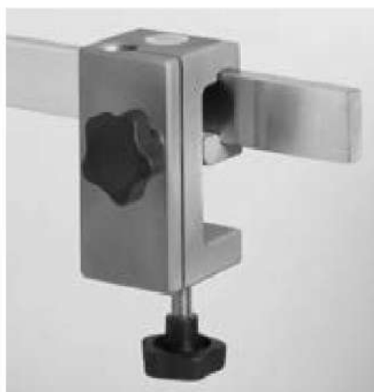
EV19799-04 Leichtmetall-Klemm- sockel Spannbreite 50 mm, für ein höhenverstellbares Stativ Ø 16 mm, für Schienen 25/35 x 8/10 und Rohre Ø 12 - 35 mm. Clamp socket made of light metal, holding width 50 mm, for height- adjustable stand Ø 16 mm, for rails 25/35 x 8/10 and tubes Ø 12 - 35 mm.
