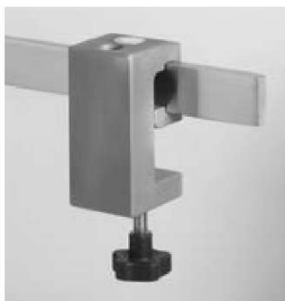
EV19799-06 Leichtmetall-Klemm- sockel Spannbreite 50 mm, für ein Schraubstativ mit Ø 16 mm/M10, für Schienen 25/35 x 8/10 und Rohre Ø 12 - 35 mm. Clamp socket made of light metal, holding width 50 mm, for screw stand Ø 16 mm/M10, for rails 25/35 x 8/10 and tubes Ø 12 - 35 mm.
