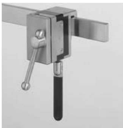
EV19799-05 Klemmsockel aus rostfreiem Stahl, für ein höhenverstellbares Stativ Ø 16 mm, elektrisch isoliert bis 4,5 kV AC, Spannbreite 50 mm für Schienen 25/32 x 8/12 mm. Clamp socket made of stainless steel, for height-adjustable stand Ø 16 mm, electrically insulated up to 4.5 kV AC, holding width of 50 mm for rails 25/32 x 8/12 mm.
