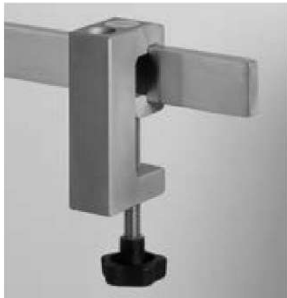
EV19799-03 Leichtmetall-Klemms- sockel Spannbreite 35 mm, für ein Schraubstativ mit Ø 16 mm/M10, für Schienen 25/35 x 8/10 und Rohre Ø 12 - 35 mm. Clamp socket made of light metal, holding width 35 mm, for screw stand Ø 16 mm/M10, for rails 25/35 x 8/10 and tubes Ø 12 - 35 mm.
